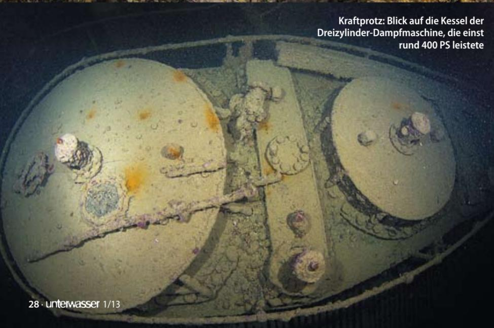
Kraftprotz: Blick auf die Kessel der Dreizylinder-Dampfmaschine, die einst rund 400 PS leistete
